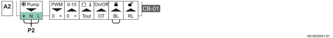
Рис.36 Электрические подключения ведущего котла A1 – SCB-10 и ведомого котла A2 – CB-01 в каскаде
